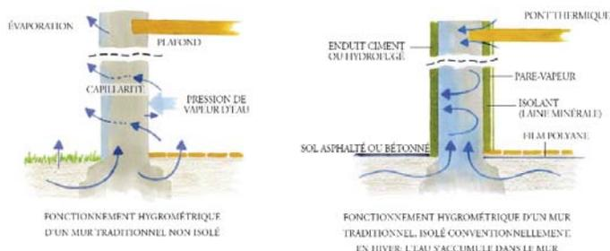
Fonctionnement hygrométrique d'un mur ancien. Source : ATHEBA
